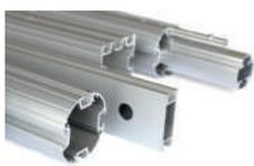
La gamme Linear est composée de 8 profilés en aluminium et a pour objectif de fournir une alternative aux structures avec habillage tissu. La construction à base de mâts rainurés et de traverses de renfort, permet d'équiper vos structures avec des visuels en PVC souples ou panneaux rigides.
